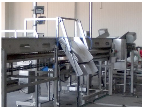
8 Línea de llenado de tinas
