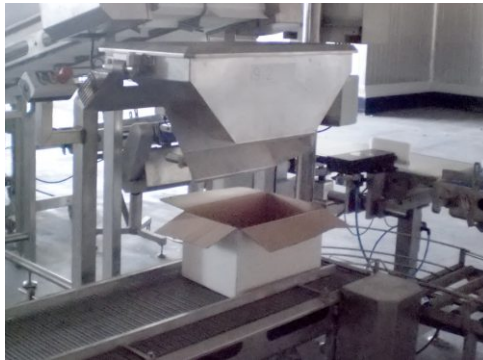
11 Línea de llenado de cajas
